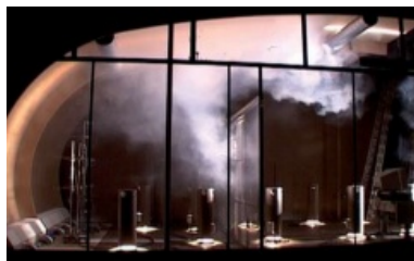
Luftstrømtester: Mock oppsett i TROX forsknings- og utviklingslaboratorium
